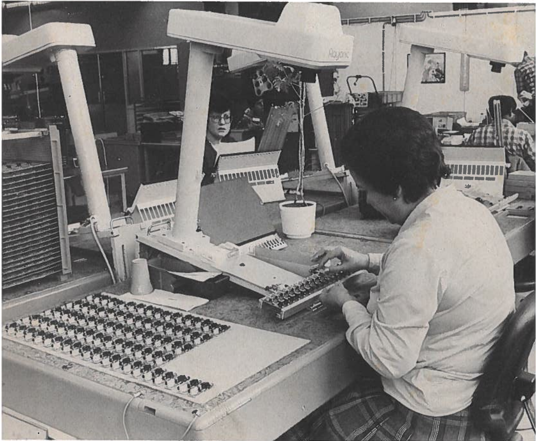
Het geprogrammeerd aanbrengen van componenten op prentplaten bij de Centrale Werkplaats PTT te Den Haag.
